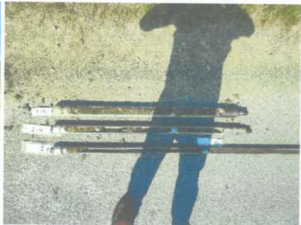
Fig. 18. Foraje geotehnice în continuare carotelor și prelevare probe de pământ
